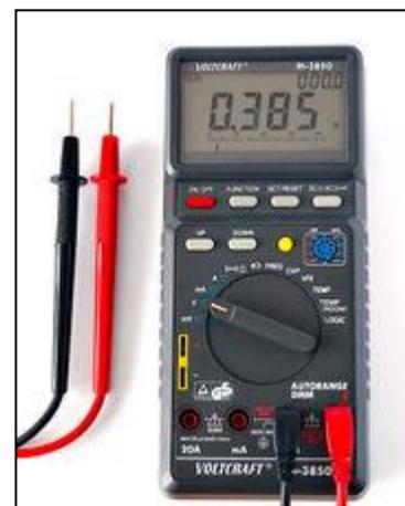
figura 13: multímetro con funciones avanzadas
