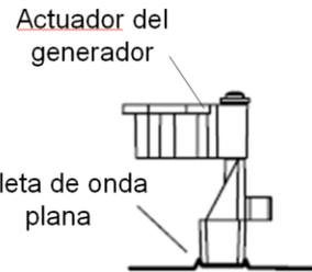
figura 13: Contacto paleta - superficie del agua
