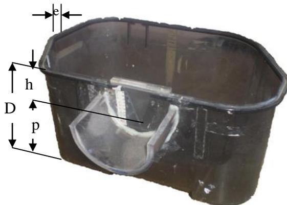
figura 1: vertedero de laboratorio de escotadura triangular
