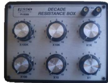
figura 4: caja o década de resistencias " $R_1$ "
