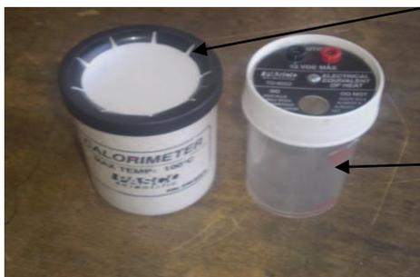
figura 2: Calorímetro (aislamiento-envase)
